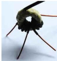
Gambar 1. Bentuk ZCT Buatan Sendiri
