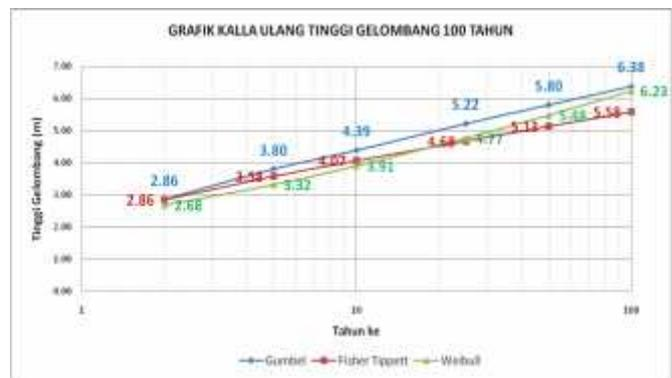
Gambar 23. Kala Ulang Tinggi gelombang Tahunan Perairan Watunohu dengan Tiga metode Statistik.
