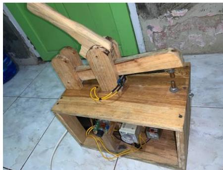
Gambar 19 Alat Las Titik (*Spot Welding*)
