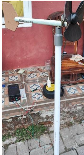
**Gambar 5. Penerapan Rancangan Sistem Monitoring PLTB Mini**
