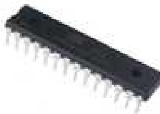
Gambar 1. Mikrokontroler ATmega328P (ATMEL, 2012).
